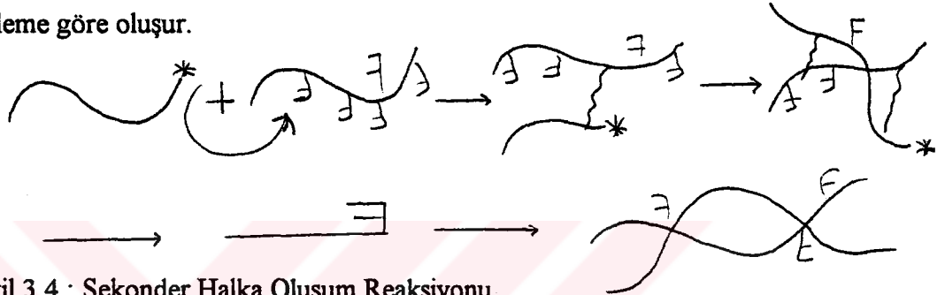
Şekil 3.4 : Sekonder Halka Oluşum Reaksiyonu
