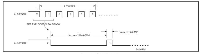
Figure 27. PROG Waveform
