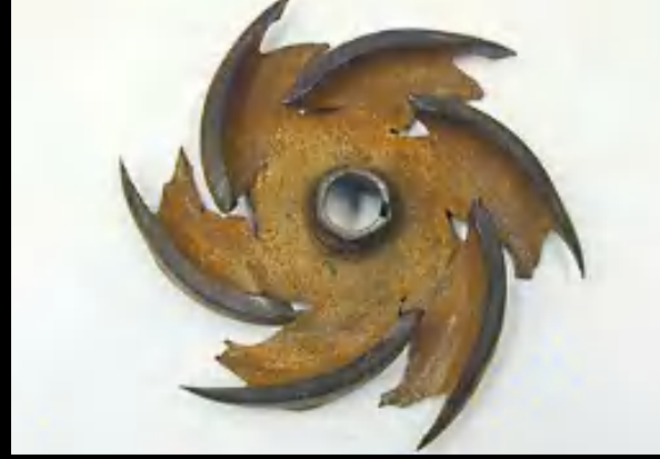
Bir maden pompasının çarkındaki eroziv aşınma
