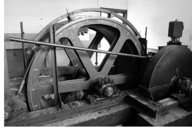
Eski bir yük asansöründe bantlı fren uygulaması
