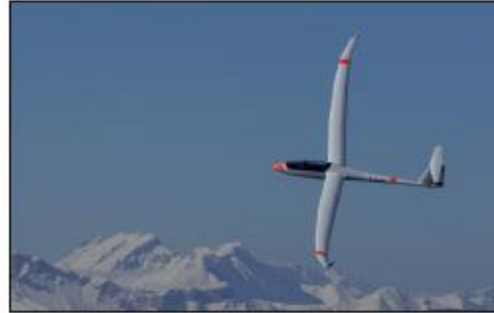
(b) Planördeki kanat uzantıları indüklenmiş direnci azaltmak için kullanılır.
