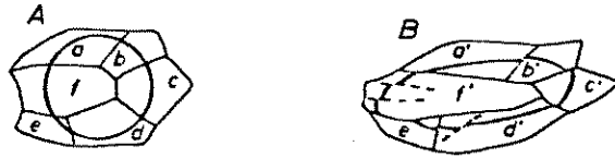
Şekil 2. 5. Yamulma elipsi ve homojen yamulma kavramları kayalara ve kayaları oluřturan kristallere her zaman uygulanamaz. A, deforme olmamıř, a-f ile gösterilen kristallere sahip ve üzerinde sanal bir çember çizili kayayı, B, ise bu kayanın ve kristallerin (a'-f') deforme olmuř şeklini göstermektedir, ilksel çember kesikli bir elipse dönüřmüřtür.
