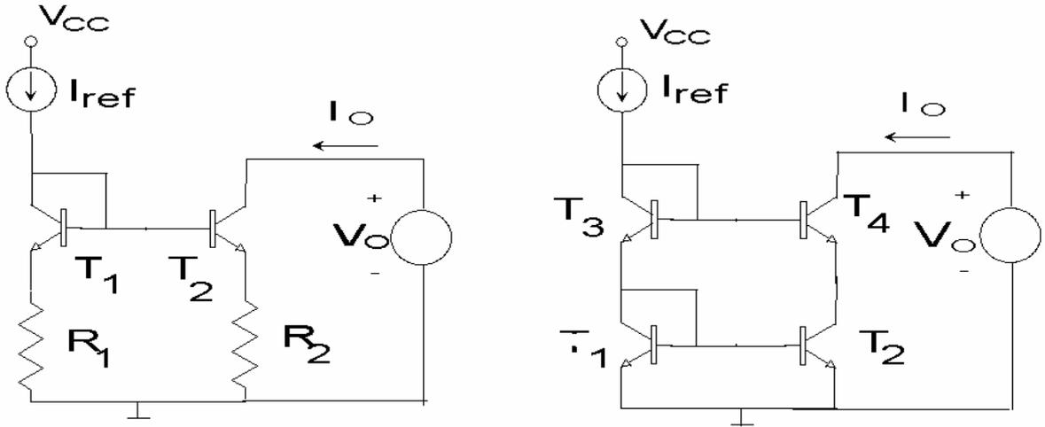
ekildeki diren oranlı akım kaynađı ve Kaskod akım kaynađı devrelerinde  $I_{ref} = 100\mu A$  deđerindedir.  $V_{CC} = 5V$  dur.
