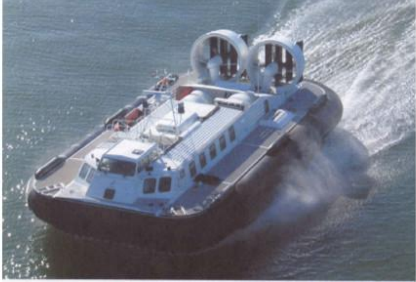
Şekil 7’de 50 yolcu kapasiteli 35 knot hıza çıkabilen hava yastıklı (hover craft) tekne gösterilmiştir
