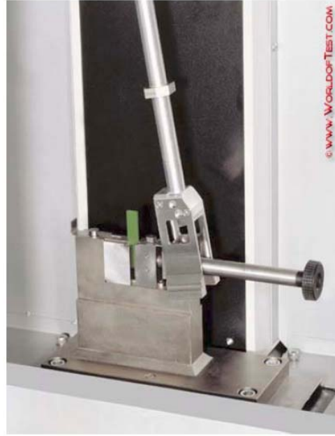
Şekil 2. Charpy (solda) ve Izod (sağda) test düzenekleri
