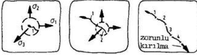
Şekil 4.19- Gecikmeli çatlak oluşumunun şematik gösterilişi (delayed fracture)
