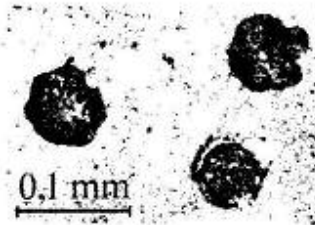
Şekil 4.105. Sfero dökme demirde grafit oluşumu
