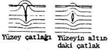
Şekil 3.81-Manyetik alan kuvvet çizgilerinin çatlaklar nedeniyle bozulması
