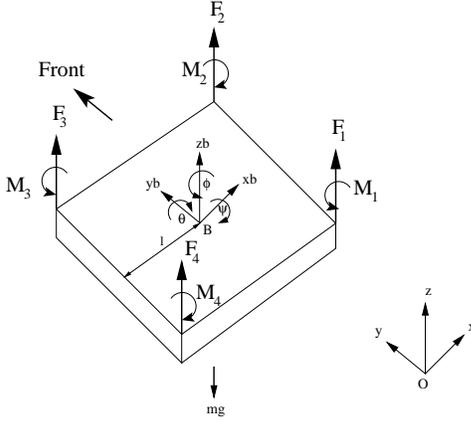
Fig. 6. 3D Quadrotor Model
