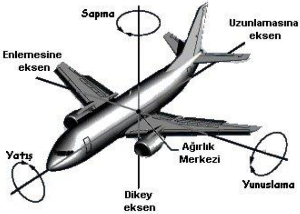
Şekil A.5 : Sabit-kanat duruş açıları.
