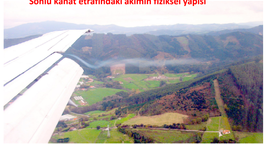
Flap tarafından oluşturulan kanat uç girdabı
