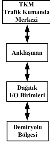
Şekil 1: Sinyalizasyon sistemi blok diyagramı
