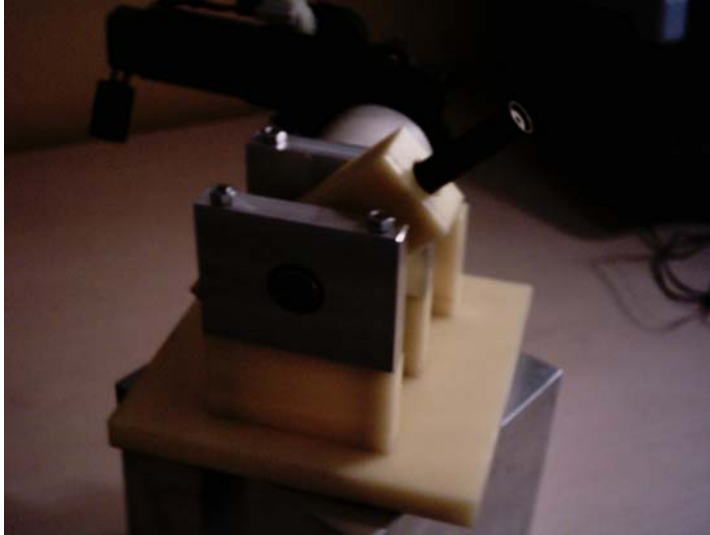
Şekil 20. İlk Örnek Taret Mekanik Modeli
