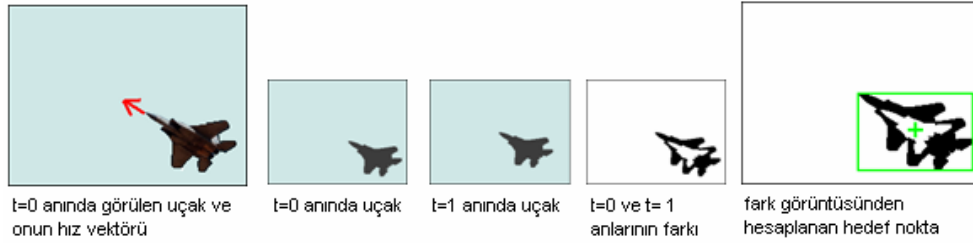
Şekil 4. Düşük hızlı cisimlerde görüntü farkları ile merkez bulma
