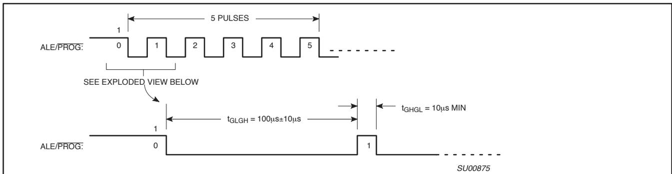
**Figure 27. PROG Waveform**
