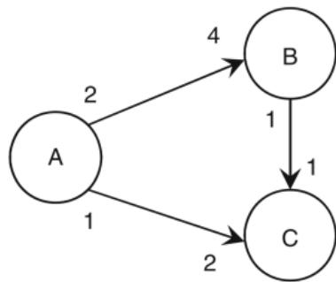
$$G = \begin{bmatrix} A & B & C \\ 2 & -4 & 0 & < -\text{edgeAtoB} \\ 1 & 0 & -2 & < -\text{edgeAtoC} \\ 0 & 1 & -1 & < -\text{edgeBtoC} \end{bmatrix}$$
