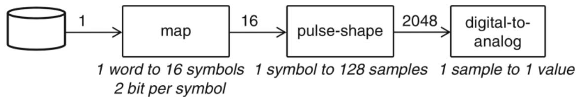
$[01110010\dots]_{32} \rightarrow [-1\ 3\ -3\ 1\dots]_{16} \rightarrow [0\dots030\dots0]_{128} \rightarrow *h(n) \rightarrow \text{DAC}$
