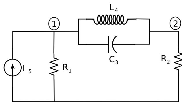
$$\begin{bmatrix} G_1 + C_3s + \frac{1}{L_3s} & -C_3s - \frac{1}{L_3s} \\ -C_3s - \frac{1}{L_3s} & G_2 + C_3s + \frac{1}{L_3s} \end{bmatrix} \begin{bmatrix} V_{d1} \\ V_{d2} \end{bmatrix} = \begin{bmatrix} I_5 \\ 0 \end{bmatrix} + \begin{bmatrix} C_3 & -\frac{1}{s} \\ -C_3 & \frac{1}{s} \end{bmatrix} \begin{bmatrix} v_3(0) \\ i_4(0) \end{bmatrix}$$
