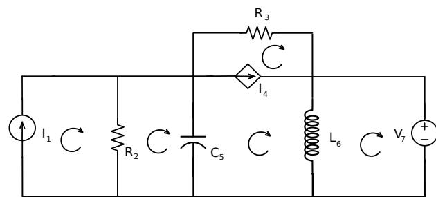
$$\begin{bmatrix} R_2 & -R_2 & 0 & 0 & 0 \\ -R_2 & R_2 + \frac{1}{C_5 s} & -\frac{1}{C_5 s} & 0 & 0 \\ 0 & -\frac{1}{C_5 s} & \frac{1}{C_5 s} + L_6 s & 0 & -L_6 s \\ 0 & 0 & 0 & R_3 & 0 \\ 0 & 0 & 0 & -L_6 s & L_6 s \end{bmatrix} \begin{bmatrix} I_{c1} \\ I_{c2} \\ I_{c3} \\ I_{c4} \\ I_{c5} \end{bmatrix}$$
