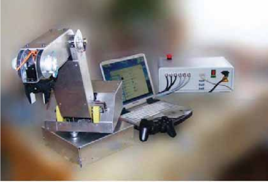
Resim 6: Yapmış olduğumuz sisteme ait görüntü. Soldan sağa doğru Robot Kol, yönetici bilgisayar ve el kumandası, sürücü ünitesi.
