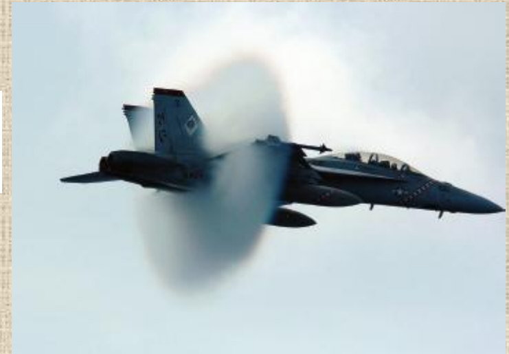
Ses hızına yakın uçan F/A-18F Super Hornet savaş uçağının etrafında oluşan buhar bulutu.
