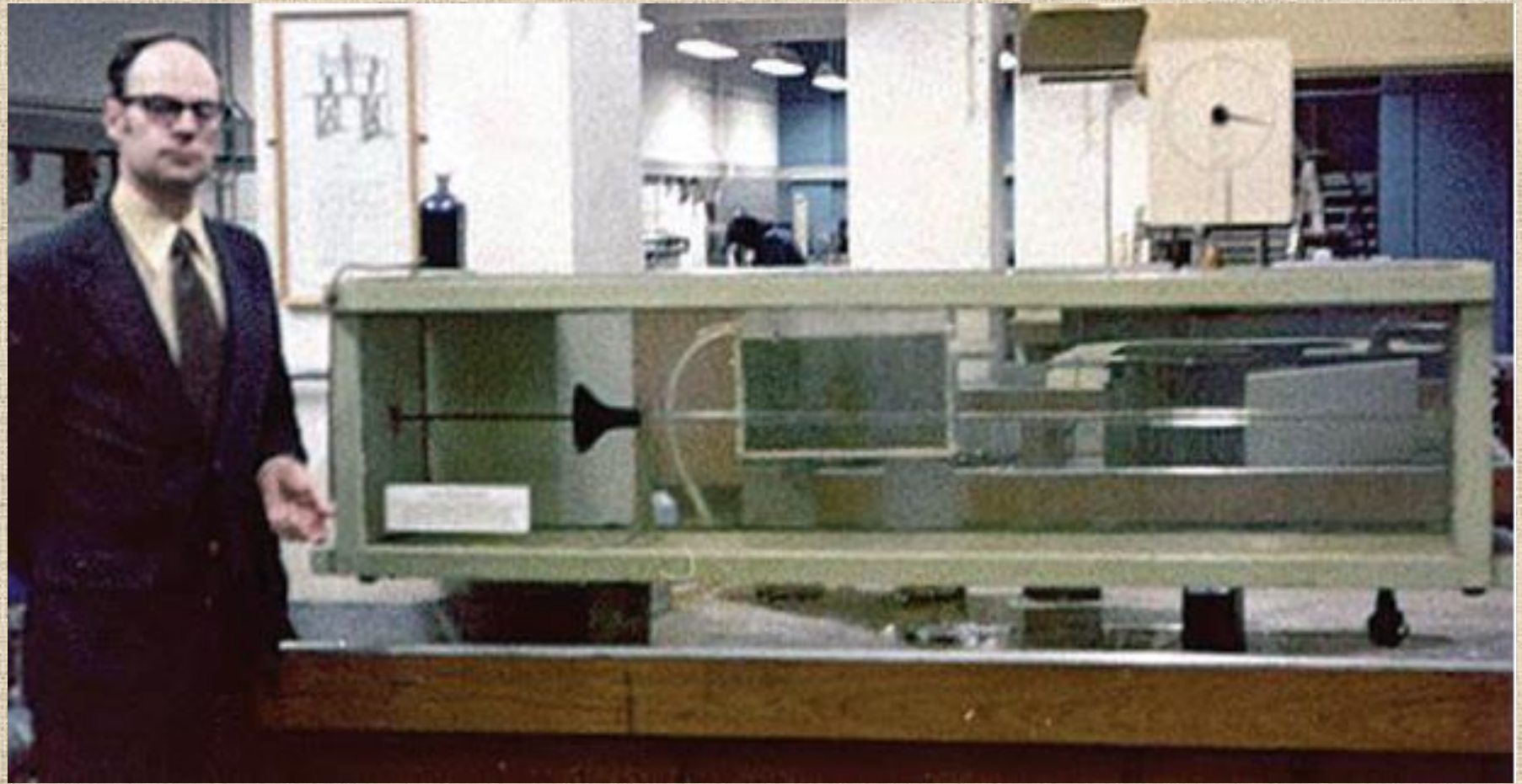
Osborne Reynolds'un borularda türbülansın başlamasını gösterdiği orijinal deney düzeneği ve bu düzeneği Manchester Üniversitesi'nde 1975 yılında kullanan John Lienhard.
