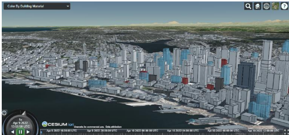
Şekil 2.27 : Cesium ile görselleştirilen 3D Tiles verisi örneği (Cesium, 2015).
