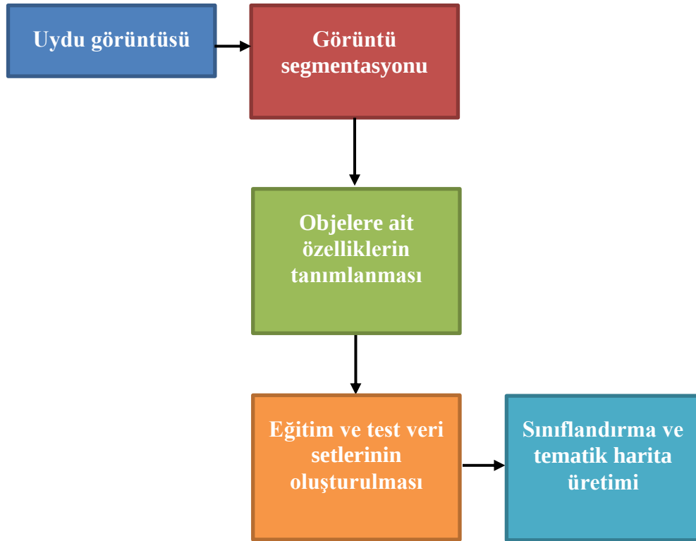
Şekil 2.8 : Obje tabanlı sınıflandırmada temel işlem adımları.
