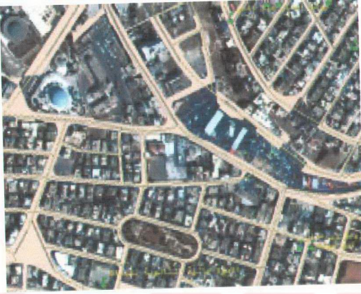
Şekil 24. İkonos görüntüsünden yol ağının elde edilmesi (Al-Hanbali vd, 2004)
