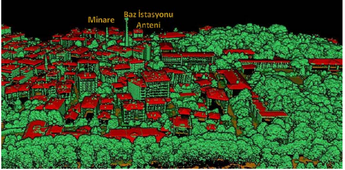
Şekil 2.13: Örnek sınıflandırılmış nokta bulutu verisi (Url-17).
