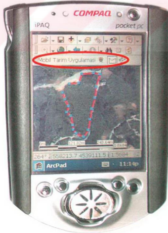
Şekil 13. Uygulama için tasarlanan araç çubuğu arayüzü
