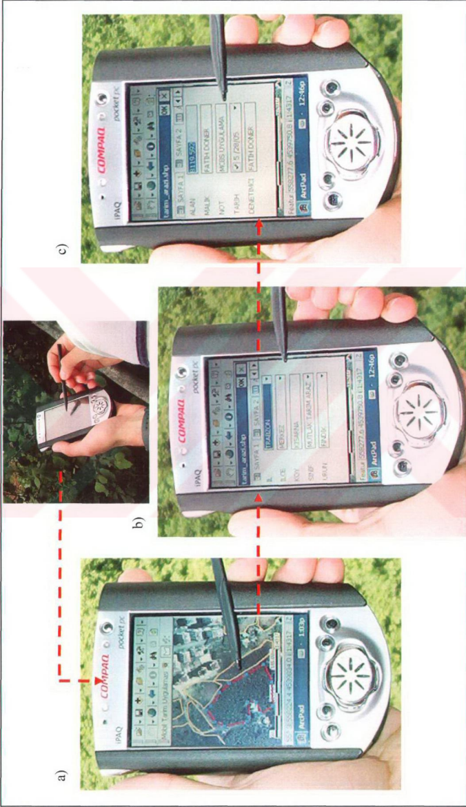
Şekil 19. Uygulama-2 ile toplanan veriler için arayüz örnekleri: a) İKONOS uydu görüntüsü üzerinde sayısallaştırılan tarım arazisini gösteren ArcPad yazılımı arayüzü, b) ve c) Tarım arazisine ait öznitelik bilgilerinin girildiği veri tabanı arayüzleri
