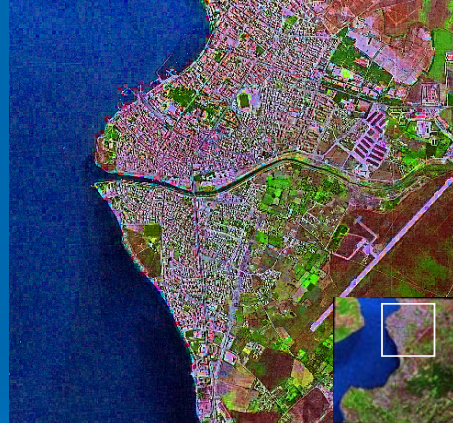
Karılmış görüntünün yüksek frekanslar toplamı ile tekrar karılarak zenginleştirilmesi
