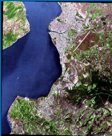
Çanakkale yöresinin IHS yöntemiyle karılarak oluşturulmuş görüntüsü
