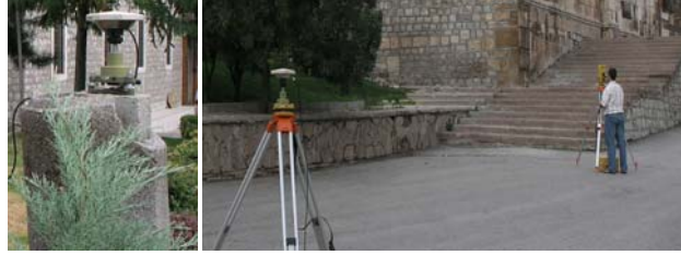
Şekil 5: Sabit GPS İstasyonu ve Kontrol noktalarının ölçümü
