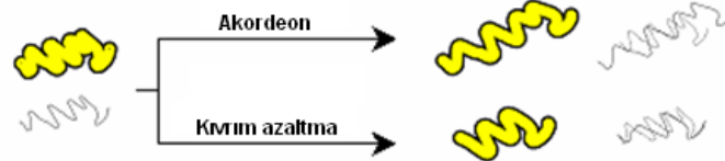
Şekil 9: Seri kıvrımlı yollar için kullanılan dönüşüm algoritmaları (Duchene vd., 2001).
