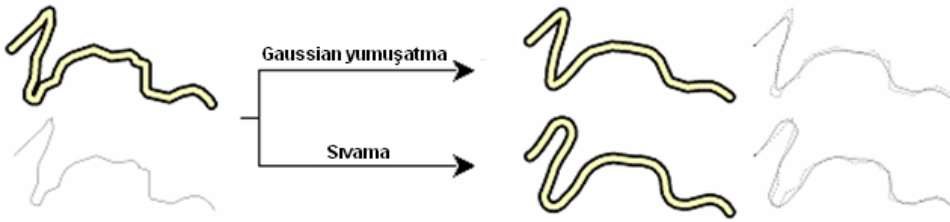
Şekil 10: Yumuşatma algoritmaları (Duchene vd., 2001).
