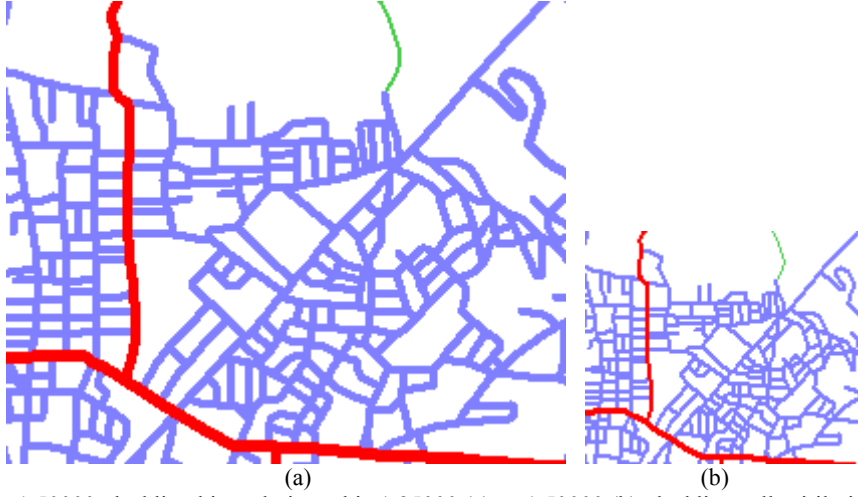
Şekil 22: 1:50000 ölçekli yol işaretlerine sahip 1:25000 (a) ve 1:50000 (b) ölçekli genelleştirilmiş görüntü.
