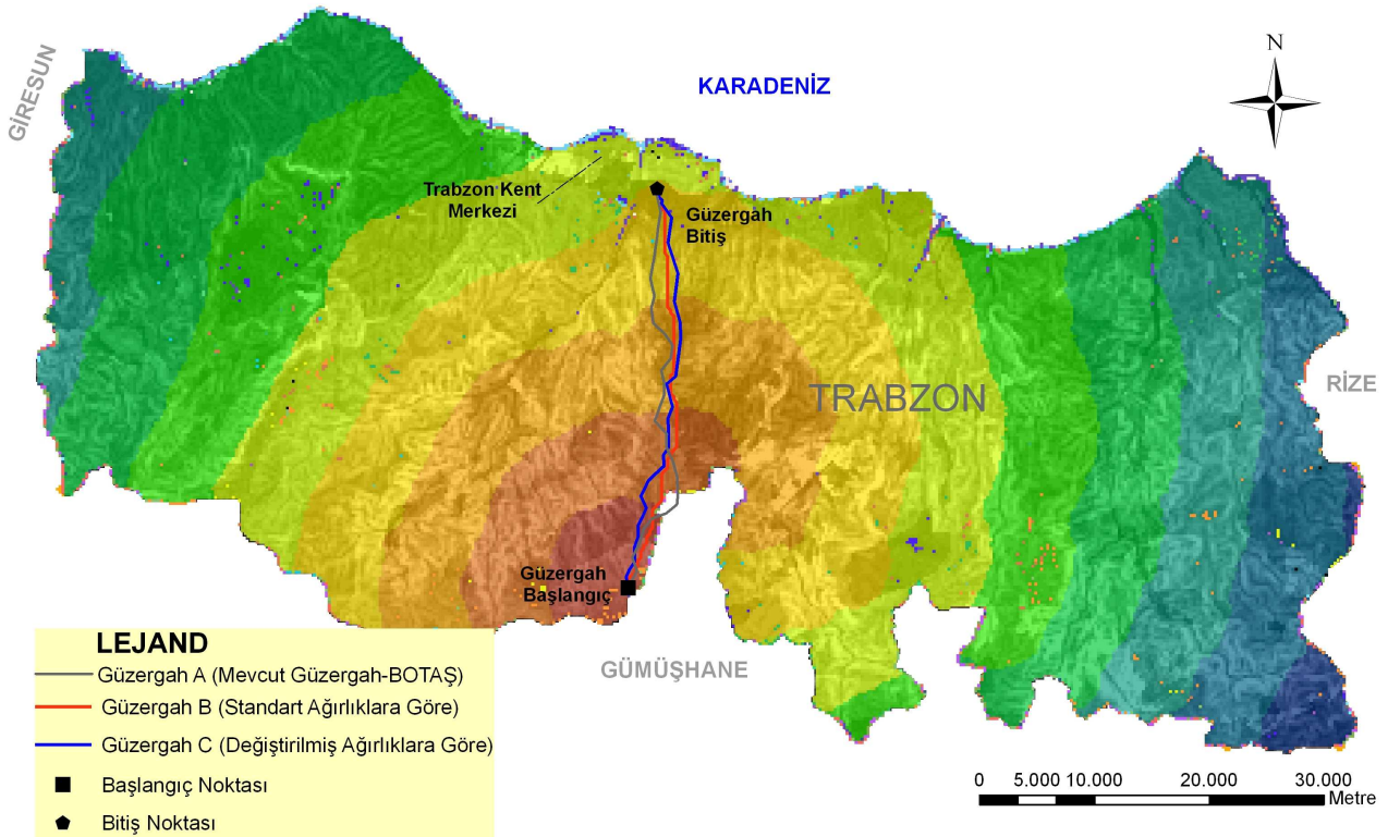
Şekil 4: CBS tabanlı raster ağ analizi teknikleri kullanılarak alternatif güzergâhların tespit edilmesi
