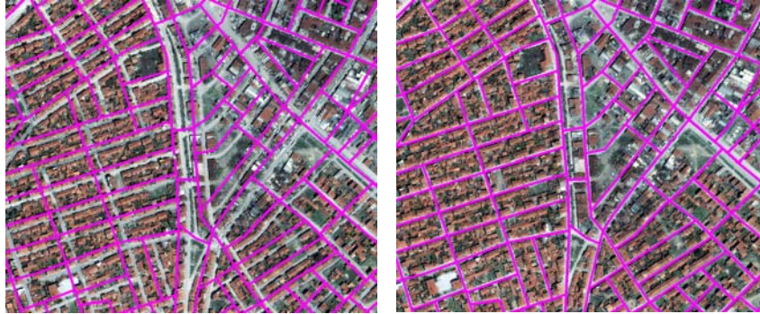
Şekil 2: Solda geometrik kodlama oransal model sonucu, sağda geometrik kodlama uydu modeli sonucu
