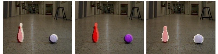
Şekil 2: LINE-MOD (solda) ve renk histogramlı LINE-MOD (ortada) ile nesne tanıma, bölütleme algoritması ile (sağda) nesne yerini saptama.
