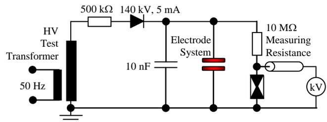
Fig. 2. Test setup
