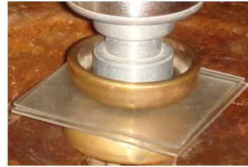
Şekil 4: Düzlem elektrotlar arasına yerleştirilmiş pleksiglas tabakalar.
