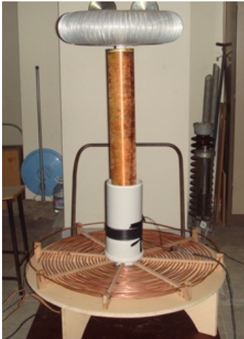
Şekil 11: Yapımı gerçekleştirilen transistor tetiklemeli Tesla üretici.
