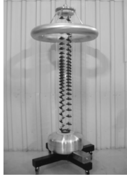
Şekil 2. Yapımı gerçekleştirilen 100 kV'luk dirençsel yüksek gerilim bölücüsü
