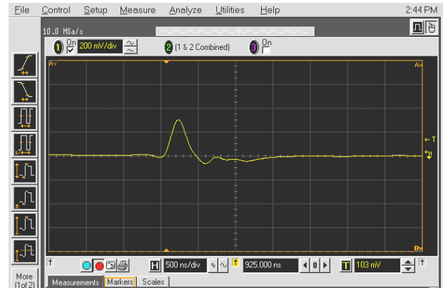
Şekil 4. Kablo üretici ile elde edilen bir darbe gerilimi
