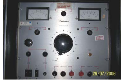
Şekil 6. Darbe üretecinde kullanılan doğru gerilim kaynağı
