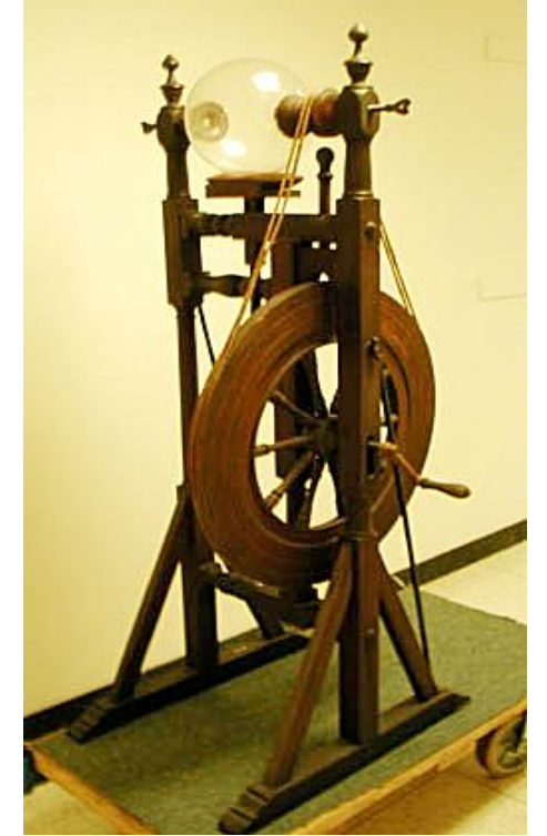
B. Franklin'ın elektrostatik üreteci
