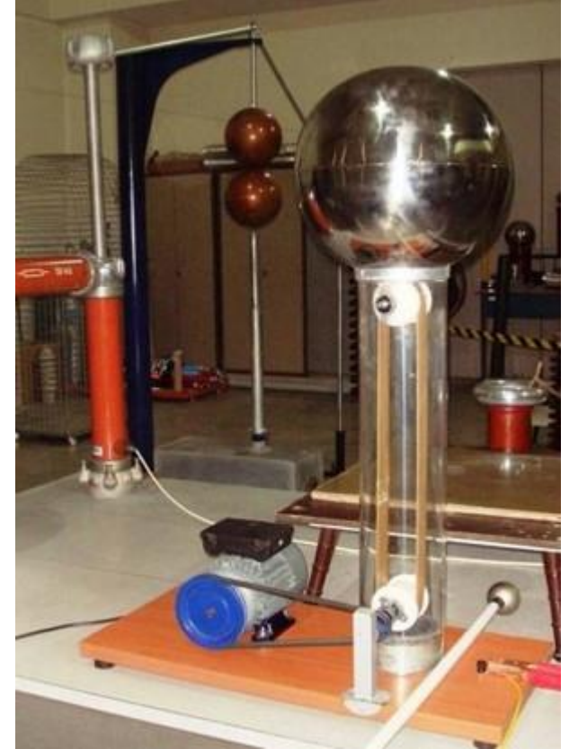
200 kV Van de Graaff üretecini İTÜ Yüksek Gerilim Laboratuvarı
