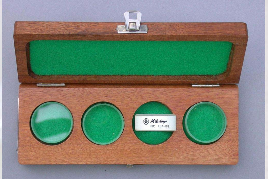
Kutu içindeki optik düzlemler. Çapı yaklaşık 1 inç (2,5 cm)
