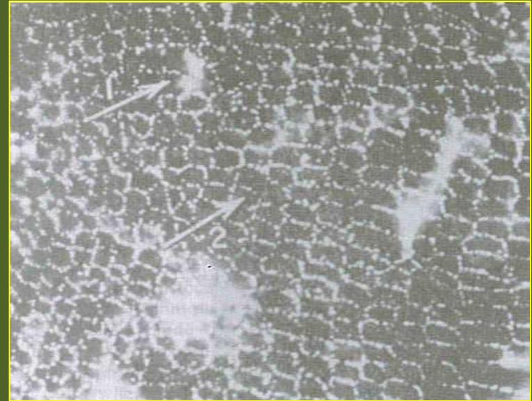
NaCl de Dekorasyon tekniđi ile saptanan Hexagonal dislokasyon ađları.
