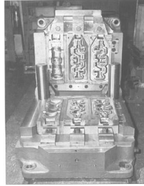
B)3000 Tonluk bir preste elle besleme yapılan progresif bir krank kalıbı
