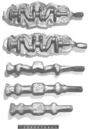
A)Altan üste doğru sıcak dövme ile bir krank milinin şekillendirilme adımları
