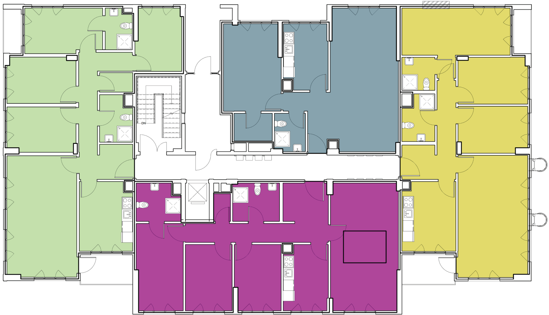
Şekil 3.39 : Autodesk Revit yazılımında örnek yapı bünyesinde oluşturulan farklı alanların (zones) gösterimi.
