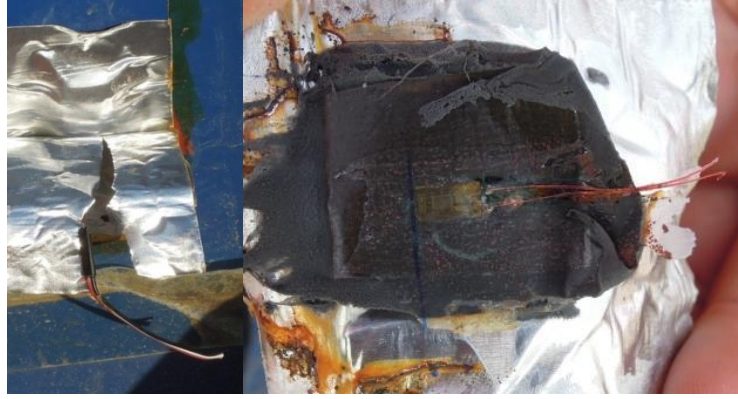
Şekil 3.4 : Kren_2_Ayak strain gage (hasarlı).
