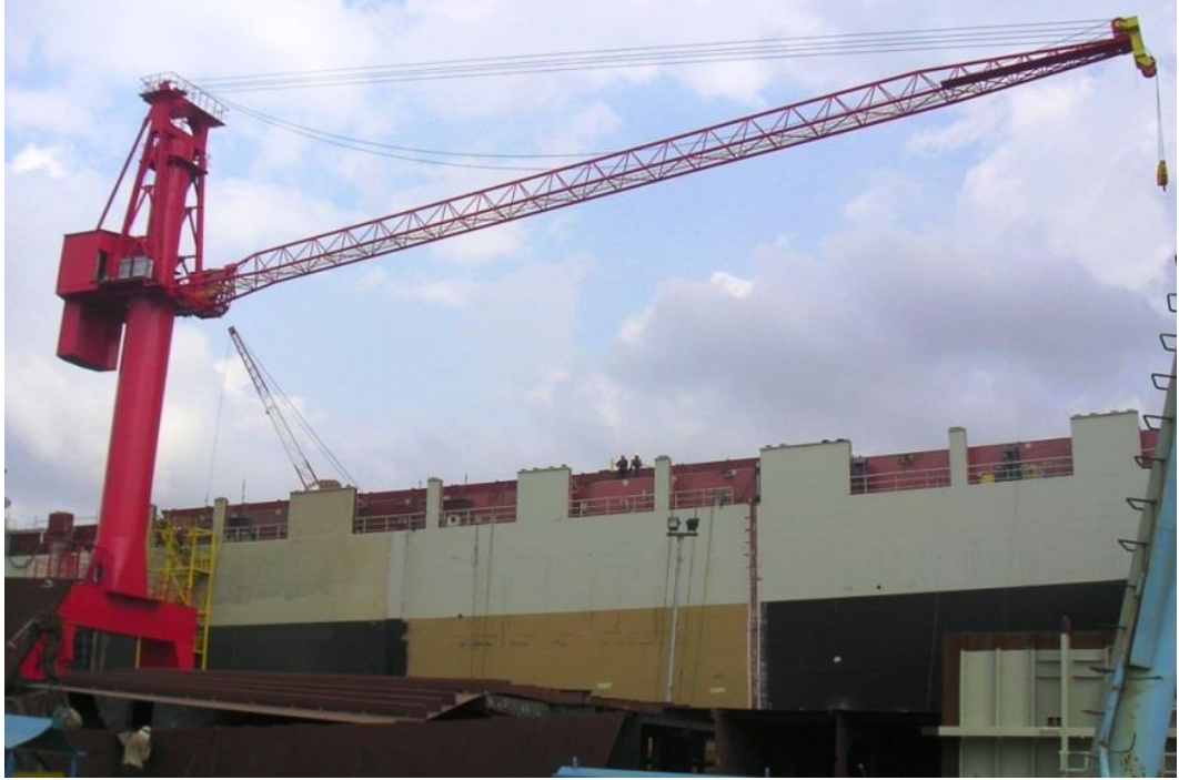
Şekil 1.8 : Silindirik gövdeli açık deniz petrol platformu jib kreni.
