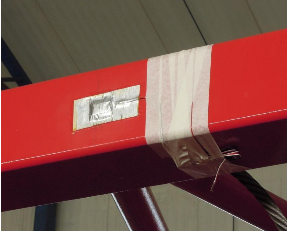
Şekil 3.3 : Koruma kiti uygulanmış strain gage.
