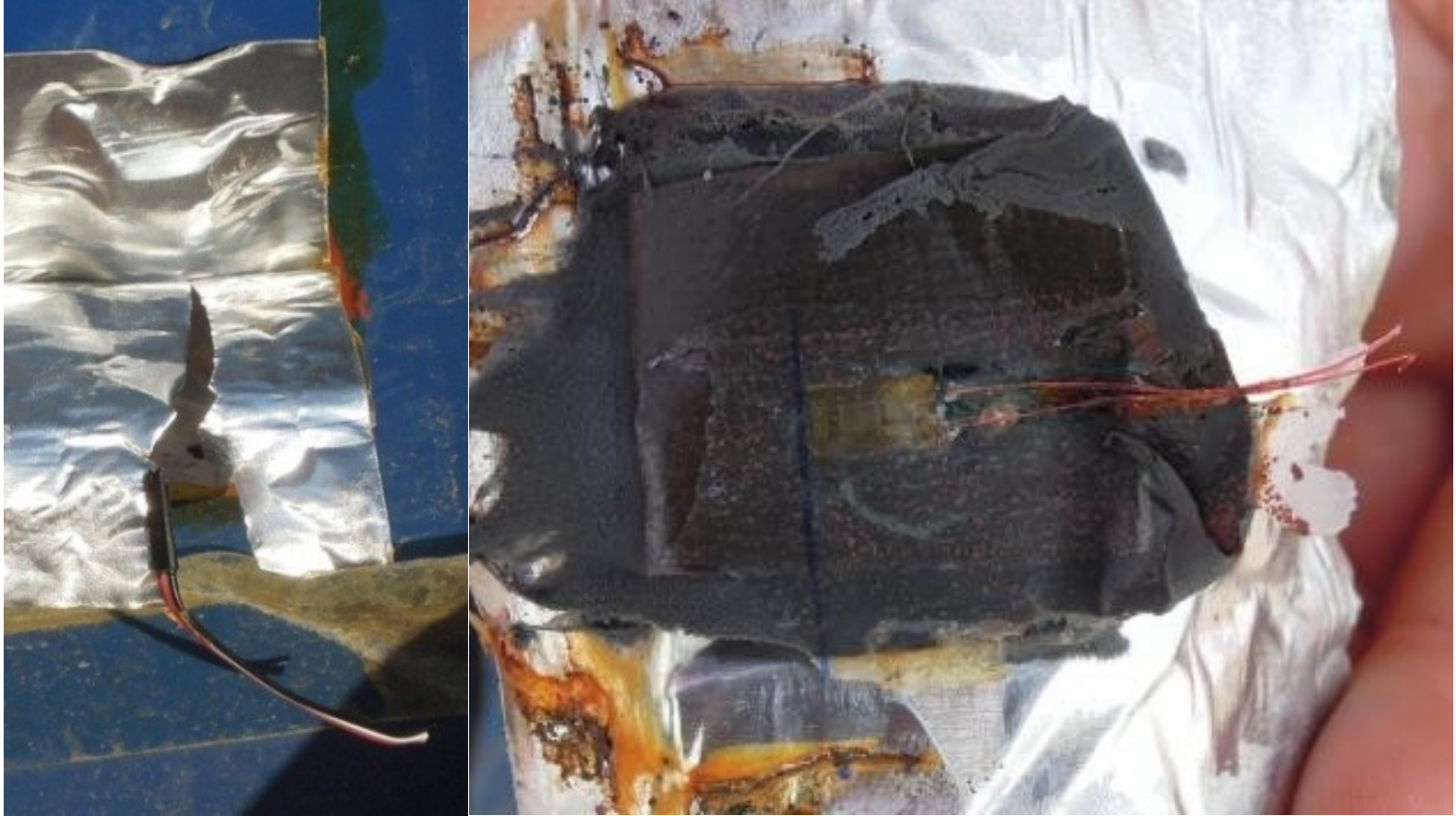
Şekil 27. Kren_2_Ayak strain gage (hasarlı)
