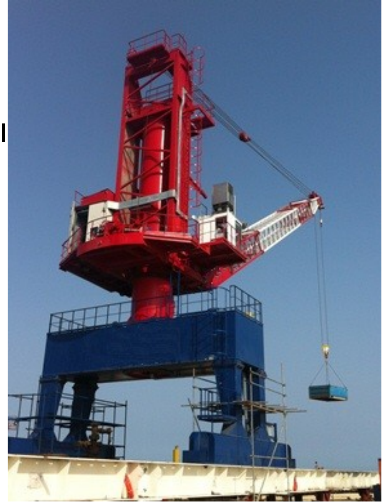
Şekil 1. Açık deniz petrol platformu jib kreni
