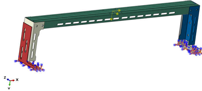
Şekil 5. Konsol Elemanı Kuvvetleri ve Kısıtları
