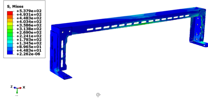
Şekil 6. Konsol Elemanı Gerilme Dağılımı (MPa)
