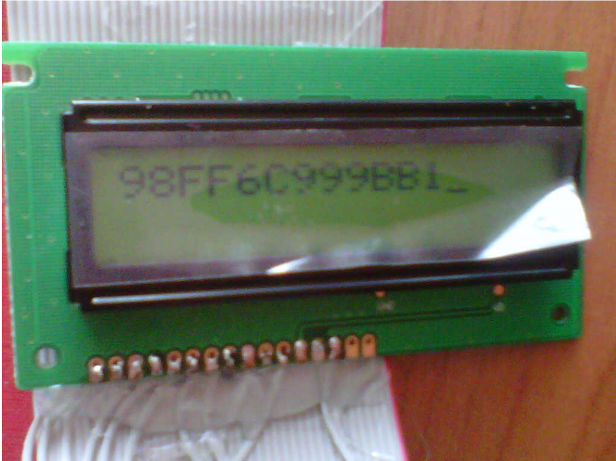
Şekil 6.3: Tek Kullanımlık Parolaların LCD Göstergede Gösterilişi
