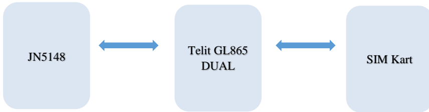
Şekil 4.7: GSM modülün mikrodenetçi ile ilişkisi
