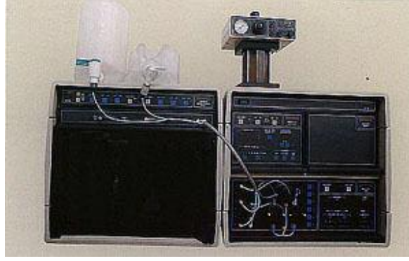
Şekil 3.2: \text{SO}_4^{2-} , \text{NO}_3^- ve \text{Cl}^- iyonlarının analizinde kullanılan İyon kromatografi aleti.
