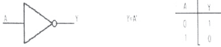
Şekil-6.5 Evirici kapısı ve doğruluk tablosu
